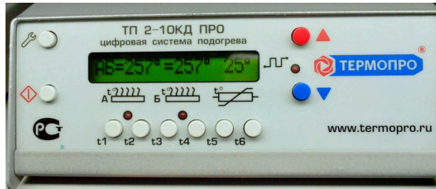
Рисунок 3. Установка температуры на регуляторе ТП 2-10 КД ПРО
