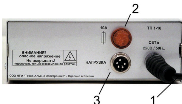
Рисунок 7.3. Задняя панель регулятора ТП 1-10
