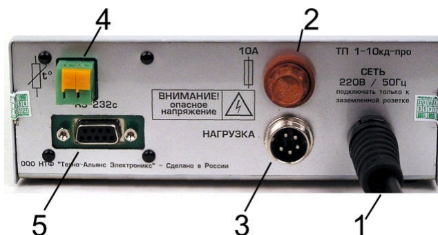
Рисунок 7.1. Задняя панель регулятора ТП 1-10 КД ПРО
