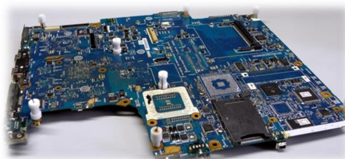
Вид платы с установленными фторопластовыми стойками с нижней стороны
