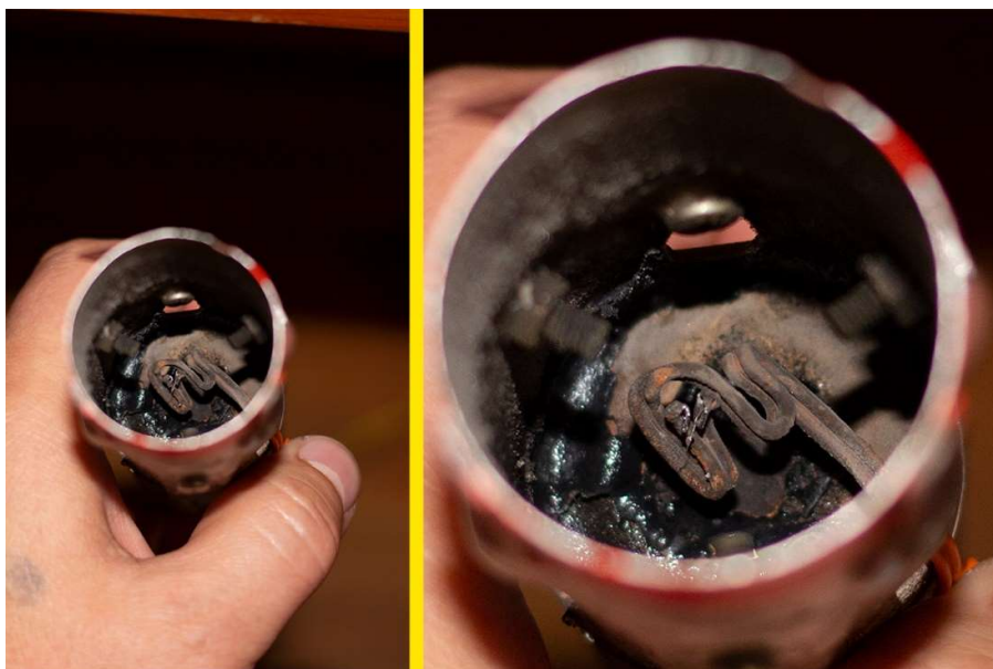
Рис10 Стакан. Вид изнутри. Виден смятый в гармошку провод электрозапала
