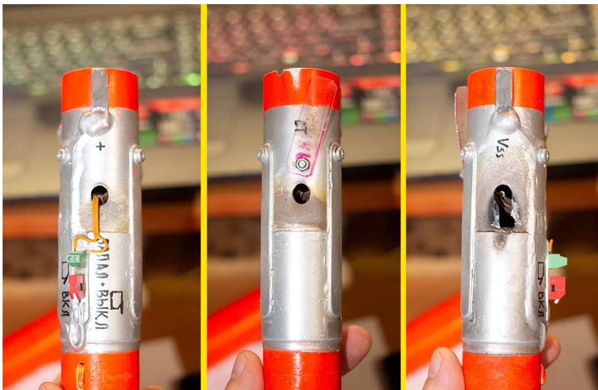
Рис9 Три проекции стыковочного стакана. Виден прожиг на третьей проекции.
